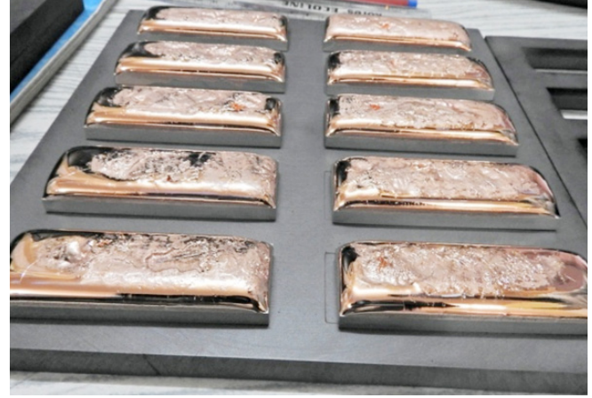
चित्र A.2.5 निर्वात ब्रेजिंग भट्टी में शुद्ध टंगस्टन टाइलों पर कॉपर कार्स्टिंग की गई।
