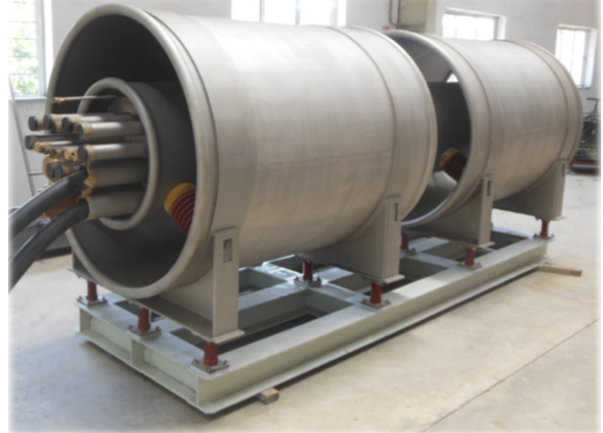
चित्र B.2.15 3.5m की उच्च वोल्टेज ट्रांसमिशन लाइन का प्रारूपी हिस्सा
