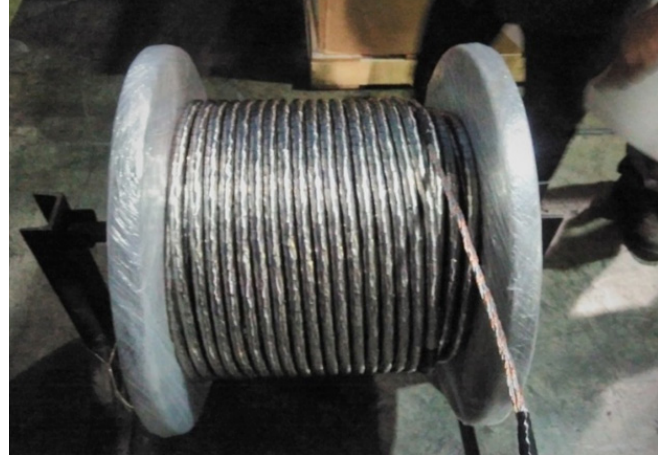
चित्र A.2.1 एसएसटी-1 अतिचालक केन्द्रीय सोलेनाइड के लिए Nb 3 Sn केबलिंग
