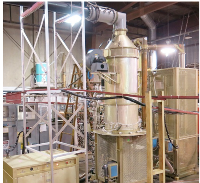
चित्र B.2.9 फैक्ट्री परीक्षणों से गुजर रही टेट्रोड आधारित प्रणाली
