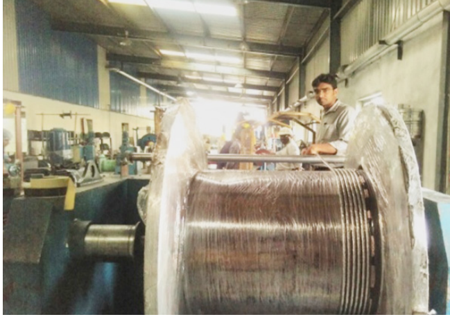
चित्र A.2.1 एसएसटी-1 अतिचालक केन्द्रीय सोलेनाइड के लिए Nb 3 Sn केबलिंग
