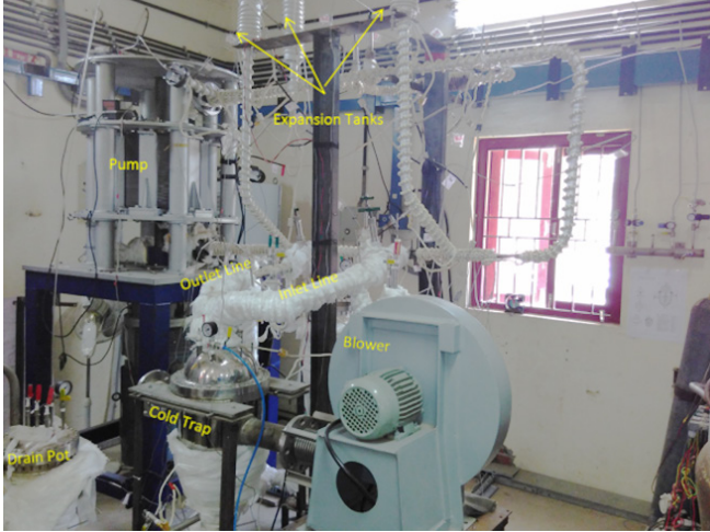
चित्र A.2.9: आईपीआर में कोल्ड ट्रेप के साथ Pb-Li शोधन लूप व्यवस्था
